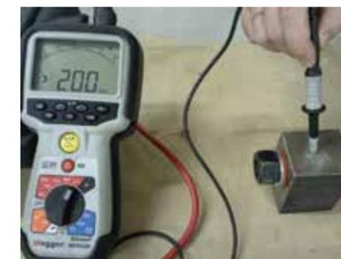
Arandela HC con arandela de respaldo de acero ZP atornillada al bloque de prueba de la arandela. La unidad de prueba de aislamiento de Megger confirma el aislamiento total de 200G Ohm a 1000V.
