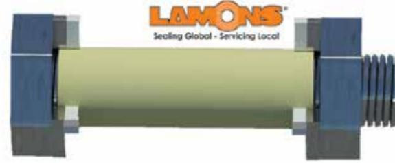
Una manga de longitud completa pasa completamente a través de ambas bridas, la junta de sellado / aislamiento, ambas arandelas de aislamiento y la mitad de las arandelas de respaldo de acero en cada lado.
